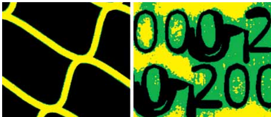
Bild 2. Überlagerungsbildausschnitte. Links: Übereinstimmung zwischen Referenz und Aufnahme und einem fehlerfreien Ausschnitt. Rechts: Fehlstelle. An den grünen Stellen sind keine Strukturen vorhanden, was auf einen Eindruck auf der Druckplatte schließen lässt.
