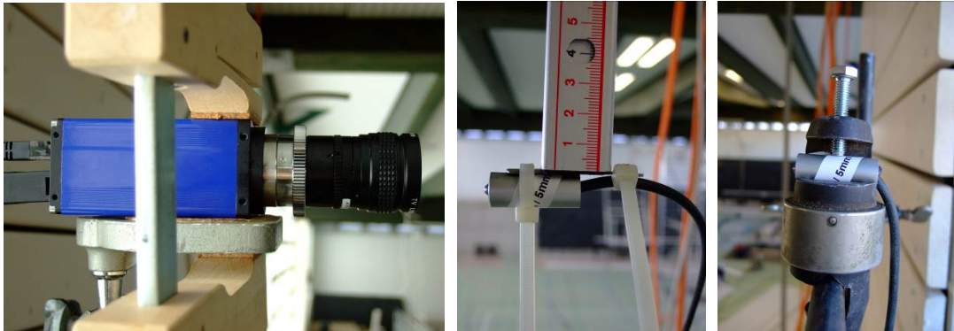
Abbildung 2: Vorversuche: Kamera (links), verschiebbliche Mess-LED (Mitte) und Referenz-LED (rechts)
